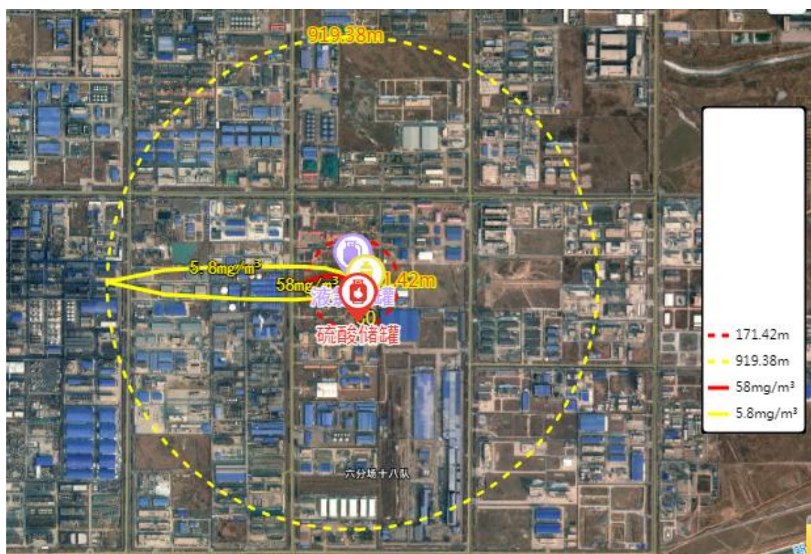
图 6.7.1-13 最不利气象条件下液氯储罐泄漏预测结果图
