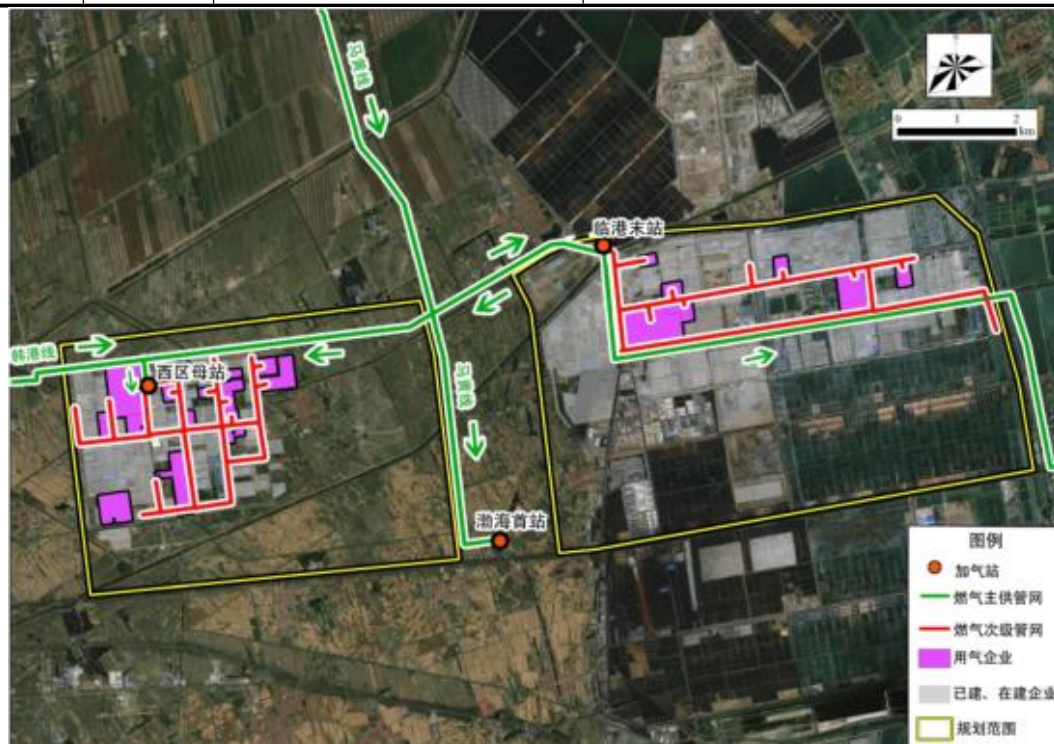
图 2.8.2-1 临港开发区供气管网图
